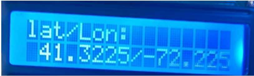
Figure 3-7. Latitude and Longitude Display Example.
